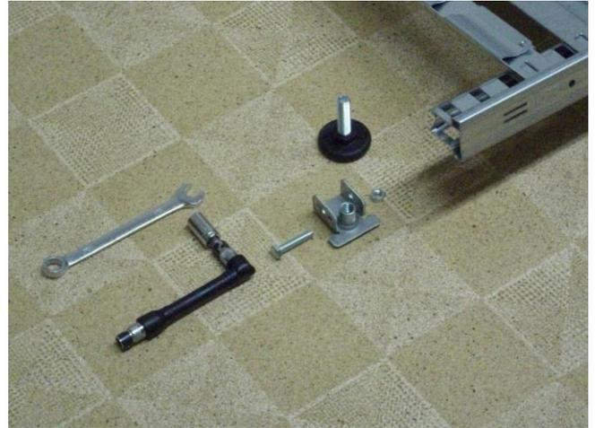
1. Halterung auf unteres Pfeilerende stecken, mit Schraube und Mutter sichern.
