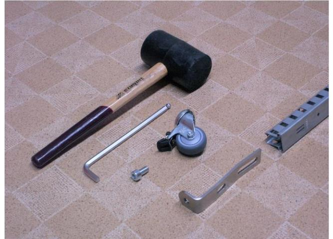
1. Halterung auf unteres Pfeilerende stecken, mit Kunststoffhammer bis zum Stopp einschlagen.
