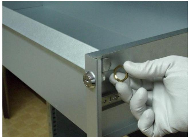
4. Riegel wie folgt mit Schraube (oder mit kleiner Mutter, je nach Ausführung) befestigen: Schlüssel im Uhrzeigersinn bis zum Anschlag drehen (Schloss verriegelt). Riegel in waagrechter Position befestigen.
