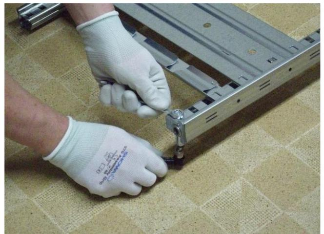
2. Fuss provisorisch einschrauben. Am fertig montierten Regal die Füsse definitiv mit Hilfe der Wasserwaage ausrichten.
