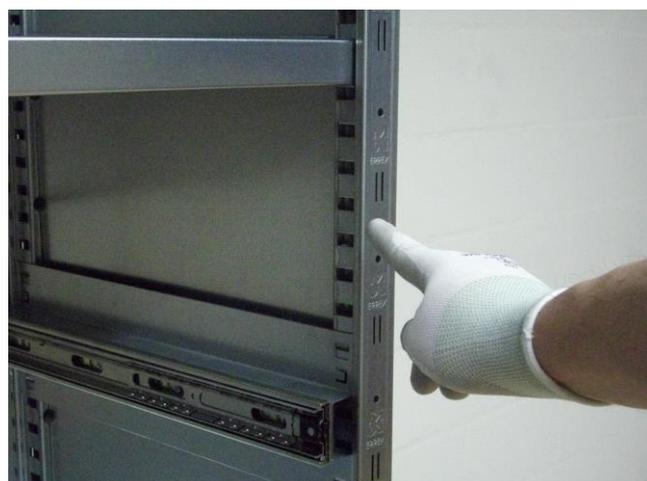
2. Innere Schienen etwas herausziehen und Schublade rechts und links gleichmässig einfahren, bis der Riegel in der Schiene einhängt.
