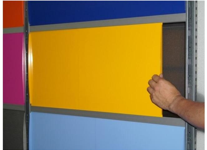
7. Türen zuerst in die obere Nut schieben, dann ausrichten und in die untere Nut stellen. Die hintere Türe zuerst einhängen.
